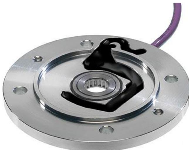
Přírubový enkodér se skládá z vulkanizovaného magnetického kroužku, který se jednoduše upevní na hřídel motoru a příruby, ve které je osazena elektronika enkodéru. Příruby mají standardní IEC rozměry a díky tomu lze enkodéry MIG bez problémů osadit na všechny konvenční motory.
